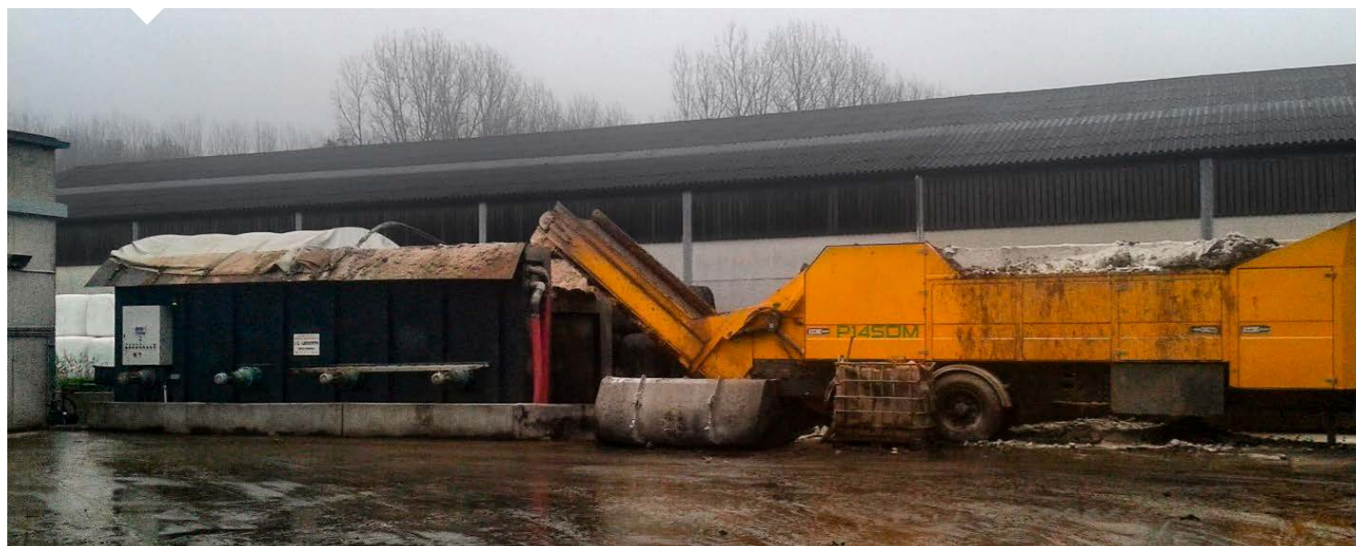
Figuur 1: De breker (rechts). Deze gaan automatisch naar de voormenger (links). Vanuit deze voormenger wordt de vergister gevoed.
