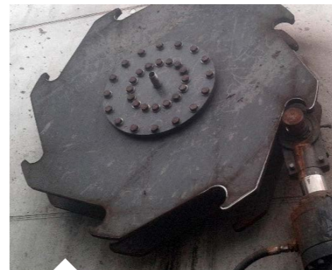
Figuur 2: Het mengsysteem van buitenaf gezien. Deze draaias wordt mechanisch rondgedraaid voor interne menging.
