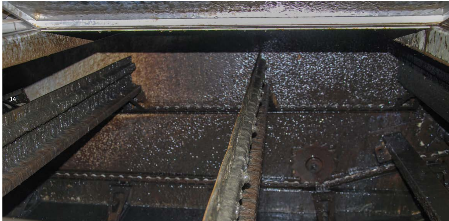
Geniaal proces: Afschrappen van de vaste stoffen bij DAF (dissolved air flocculation)
