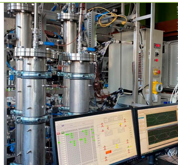
Experimentele Pressure Swing Adsorption opstelling voor de scheiding van gasmengsels.
