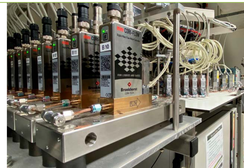
Hoge-doorvoer opstelling voor het testen van materialen om onzuiverheden uit gasstromen te verwijderen.
